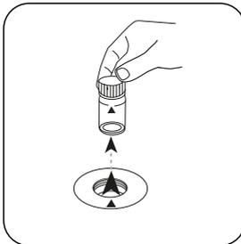
Prelevare la cuvetta dal vano di misurazione.
