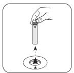
Die **Küvette** aus dem Messschacht nehmen.
