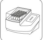
Растворите (содержимое) кюветы в течение **30 минут при температуре 100 °C** в термореакторе.
