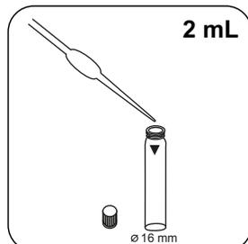
Añadir **2 mL de 1,54 N solución de hidróxido sódico** de la muestra disgregada.
