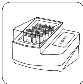
Растворите (содержимое) кюветы в течение **30 минут при температуре 100 °C** в термореакторе.
