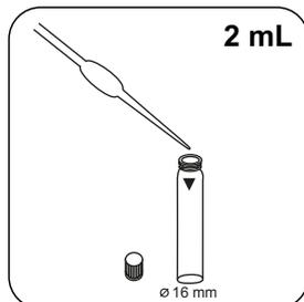
Добавьте **2 мл 1,54 N Sodium Hydroxide Solution** в растворенную пробу.
