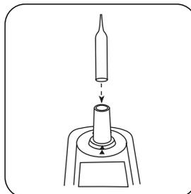
Retirez l'ampoule du blanc de la chambre de mesure.
