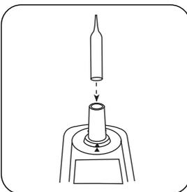
Posizionare la fiala nel vano di misurazione.
