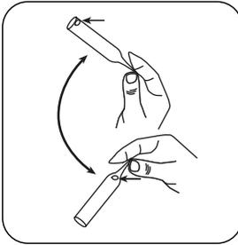
Mettez l'ampoule plusieurs fois à l'envers de manière à ce que la bulle d'air passe d'une extrémité à l'autre. Ensuite, séchez de l'extérieur.
