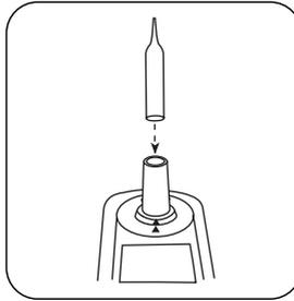
Placez l'ampoule dans la chambre de mesure.
