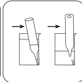
将 Vacu-vial® 安瓿放入样品容器中。轻轻按压容器壁，折断安瓿尖端。等待安瓿完全充满。
