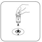
Prelevare la cuvetta dal vano di misurazione.
