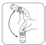
Tablette(n) durch Umschwenken lösen.
