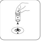
Küvette aus dem Messschacht nehmen.
