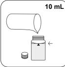
24-mm-Küvette mit 10 mL Küvette(n) verschließen. Probe füllen.
