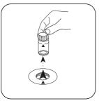
Prelevare la cuvetta dal vano di misurazione.
