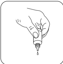
**Calciumhärte Puffer CH2** tropfenweise derselben Probe zugeben bis eine schwach rosa bis rote Färbung auftritt. (**Achtung: nach Zugabe jedes Tropfens die Probe schwenken!**)
