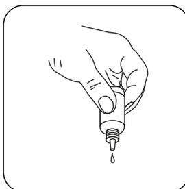
Añadir gota a gota **Hardness Calcium Buffer CH2** en la misma muestra hasta que adquiera una coloración de rosa pálido a roja. (**¡Atención: después de añadir cada gota debe agitarse la muestra!**)
