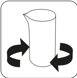
Das Aufschlussgefäß umschwenken und auf Raumtemperatur abkühlen lassen.
