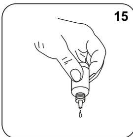
Adicionar **15 gotas KS278 (50% ácido sulfúrico)**.
