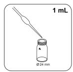
Aioutez 1 mL de solution (25 drops) Polyacrylate Buffer A1 dans la cuvette réservée à l'échantillon.
