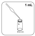
Ajoutez 1 mL de solution (25 drops) Polyacrylate Precipitant A2 dans la cuvette réservée à l'échantillon.
