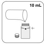
Remplissez une cuvette de Fermez la(les) cuvette(s). 24 mm de 10 mL d'échantillon.
