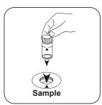
Placez la cuvette réservée Appuyez sur la touche à l'échantillon dans la chambre de mesure. Attention à la positionner correctement.
