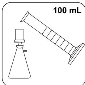
用预清洗的过滤器（孔径  $0.45\mu\text{m}$ ）过滤大约 100 mL 的样本。
