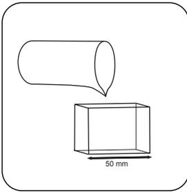
Eine **50-mm-Küvette** mit **Probe** füllen.
