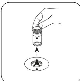
Prelevare la cuvetta dal vano di misurazione.
