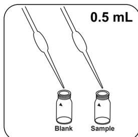
Dans chaque cuvette, versez **0.5 mL de solution VARIO Sulfide 2**.
