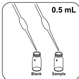
Dans chaque cuvette, versez **0.5 mL de solution VARIO Sulfide 1**.
