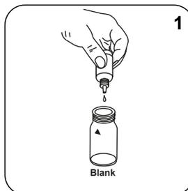
Ajoutez **1 goutte de Vario ALUMINIUM ECR Masking Reagent** dans la cuvette du blanc.
