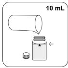
24-mm-Küvette mit 10 mL Küvette(n) verschließen. Probe füllen.
