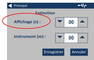
5b - Réglez à l'aide des flèches haut et bas le délai avant extinction de l'instrument en cas d'inactivité.
