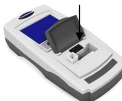
4 - Fermez le couvercle d'échantillon et appuyez sur la touche d'essai du clavier ou de l'écran.
