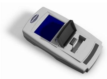
2 - Insérez le diviseur de cuve dans la rainure de la chambre d'échantillon comme indiqué et fermez le couvercle.
