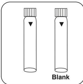
Preparar duas **células TN Acid LR/HR (Reagent C)**. Identificar uma célula como célula zero.
