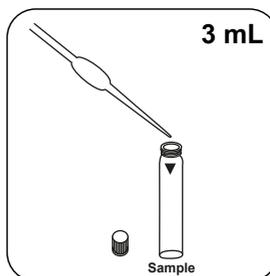
Adicionar **3 mL de amostra** à célula de amostra.
