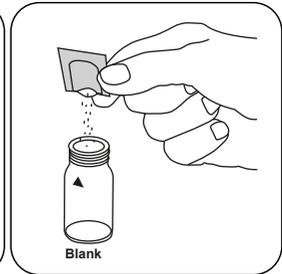
Adicionar à célula zero um pacote de pó CU3 Masking F10 .
