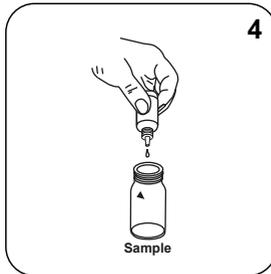
Adicionar **4 gotas Ca Mg Hardness SOL 2 (frasco azul)** à célula de amostra.
