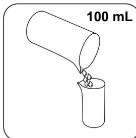
Encher a amostra com **água desmineralizada até 100 mL** .
