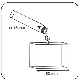
Encher a célula de 50 mm com a amostra preparada.
