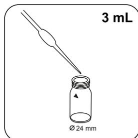
Adicionar 3 mL de água desmineralizada à célula zero.
