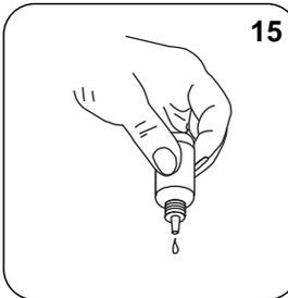
Adicionar **15 gotas KS278 (50% ácido sulfúrico)**.
