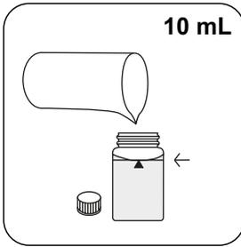
Encher a célula de 24 mm com **10 mL de amostra**.
