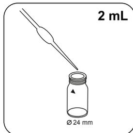
Adicionar à célula de 24 mm **exatamente 2 mL SPADNS reagent solution**.
