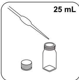
Encher uma célula de digestão com **25 mL de amostra preparada**.
