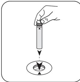
Colocar a **c3lula de amostra** no compartimento de mediç3o. Observar o posicionamento.
