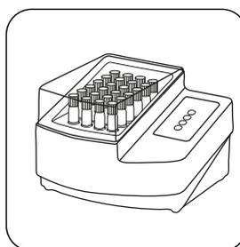
Aquecer a célula durante **120 minutos a 120 °C** no reator térmico pré-aquecido **invertida**.
