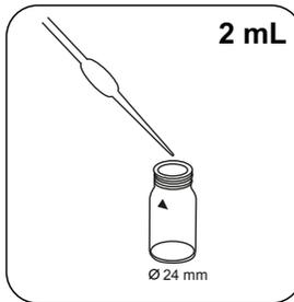
Adicionar à célula de 24 mm **exactamente 2 mL SPADNS AF reagent solution**.
