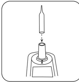
Colocar a ampola no compartimento de medição.
