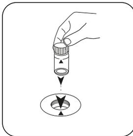
Colocar a **célula** Ammoniano compartimento de medição. Observar o posicionamento.
