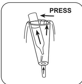
Posicionar uma ampola Vacu-vial® no recipiente de recolha da amostra. Partir a ponta da ampola pressionando ligeiramente contra a parede do recipiente. Aguardar o enchimento total da ampola.
