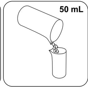
Encher a amostra com **água desmineralizada até 50 mL**.
