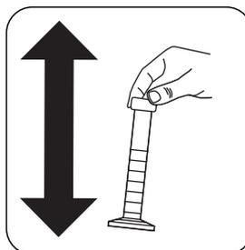
Fechar o cilindro misturador com um tampão. Dissolver o pó agitando.
