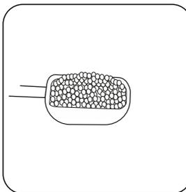
Adicionar **uma micro-tíler de NITRATE TEST pó**.
