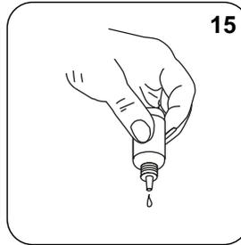
Adicionar **15 gotas KS278 (50% ácido sulfúrico)**.
