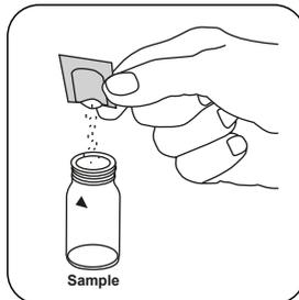
Adicionar um **pacote de pó Vario Silica HR Molybdate F10**.
