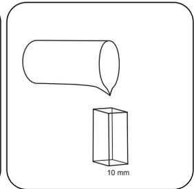
Encher a **célula de 10 mm** com amostra.
