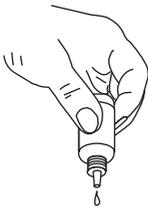
Manter os frascos conta gotas na vertical e pressionar lentamente para adicionar gotas de igual dimensão.
