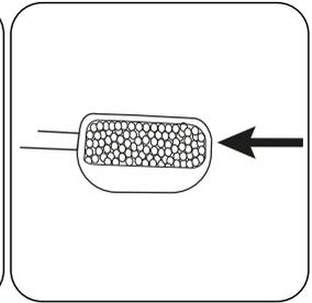
Adicionar **uma colher medida com traços No. 8 (preto) Digestion Reagent**.
