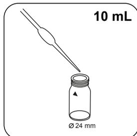
Encher a célula de 24 mm com **exatamente 10 mL de amostra**.
