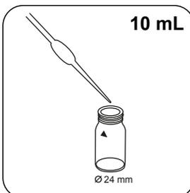
Encher a cubeta de zero com **exatamente 10 mL** de água desionizada.
