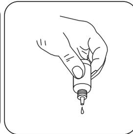
Adicionar **Hardness Calcium Buffer CH2** gota a gota da mesma amostra até aparecer uma coloração ligeiramente rosa a avermelhada. **(Atenção: assim que adicionar cada gota, agite a amostra!)**
