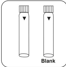
Preparar duas cuvetes de **Ammonium Diluent Reagent LR**. Identificar uma célula como célula zero.
