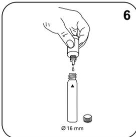
Adicionar **6 gotas H<sub>2</sub>O<sub>2</sub>-Reagent Solution**.
