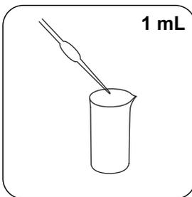
Adicionar **1 mL ácido sulfúrico concentrado** .
