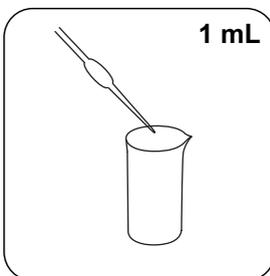
Adicionar **1 mL ácido sulfúrico concentrado** .
