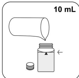
Encher a célula de 24 mm com **10 mL de água desmineralizada**.
