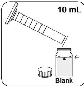
Adicionar **10 mL de amostra preparada não digerida** à célula zero.
