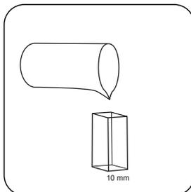
Encher a **célula de 10 mm** com a **amostra zero**.
