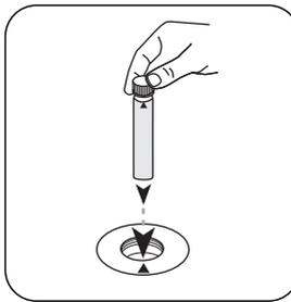
Colocar a **c3lula zero** no compartimento de mediç3o. Observar o posicionamento.
