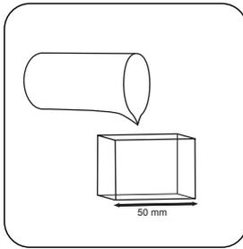
Encher a **célula de 50 mm** com **amostra**.
