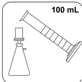
Filtrar cerca de 100 mL de amostra com um filtro pré-enxaguado (dimensão dos poros 0,45  $\mu\text{m}$ ).
