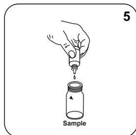
Adicionar **5 gotas Free Chlorine Reagent Solution** à célula de amostra.
