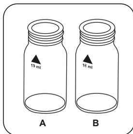
Preparar dois cuvetes de 24 mm limpos. Marcar um cubeta como Cloramina e o outro como Cloro.
