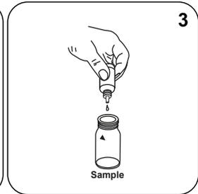
Adicionar **3 gotas Ca Mg Hardness SOL 1 (frasco vermelho)** à célula de amostra.
