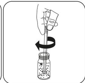
Agitar a(s) pastilha(s) para dissolver com uma vareta agitadora limpa.
