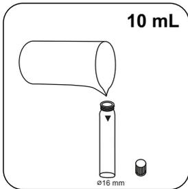
Encher a célula de 16 mm com **10 mL** de amostra .
