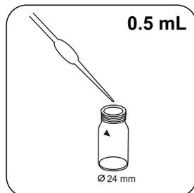
Adicionar **0.5 mL Molybdenum 2 LR de solução** à célula de amostra.
