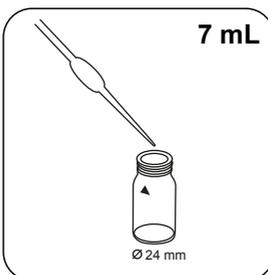
Encher a célula de 24 mm com **7 mL de água desmineralizada**.
