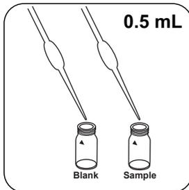
Introduzir em cada célula **0.5 mL VARIO Sulfide 2 de solução**.
