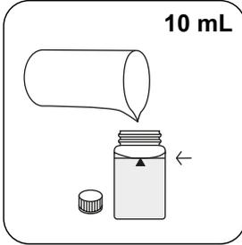
Encher a célula de PTSA mm com **10 mL de amostra**.
