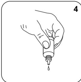
Adicionar **4 gotas Ca Mg Hardness SOL 2 (frasco azul)**.
