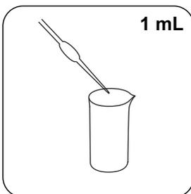
Adicionar **1 mL ácido sulfúrico concentrado** .
