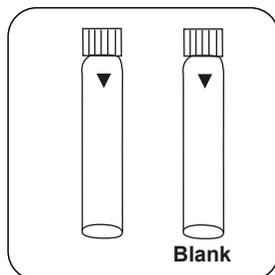
Preparar duas **células de digestão TN Hydroxide HR**. Identificar uma célula como célula zero.
