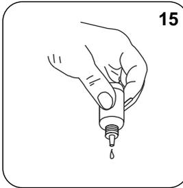
Adicionar **15 gotas KS278 (50% ácido sulfúrico)**.
