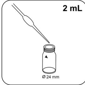
Adicionar **2 mL de amostra** e **8 mL de água desmineralizada** à célula de amostra.
