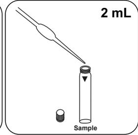
Adicionar **2 mL de amostra** à célula de amostra.
