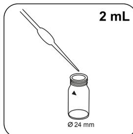
Adicionar **exatamente 2 mL SPADNS AF reagent solution de reagente.**
