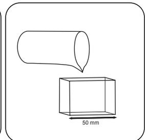
Encher a **célula de 50 mm** com amostra.
