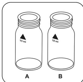
Preparar dois cuvets de 24 mm limpos. Marcar um cubeta como Amostra zero e o outro como Amostra.
