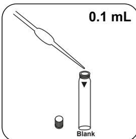
Adicionar **0.1 mL de água desmineralizada** à célula zero.
