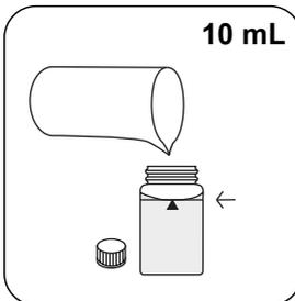
MD50: Encher a célula de 24 mm com **10 mL de amostra** .
