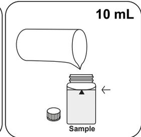
Adicionar **10 mL de amostra** à célula de amostra.
