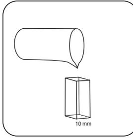
Encher a **célula de 10 mm** com **amostra**.
