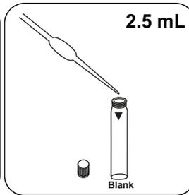
Adicionar **2.5 mL de água desmineralizada** à célula zero.
