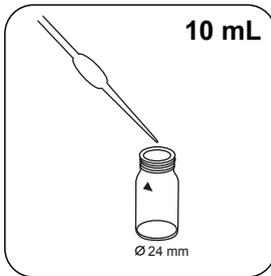
Adicionar **exacta 10 mL de amostra** à célula de amostra.
