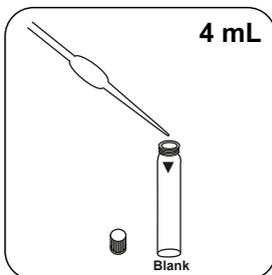
Adicionar **4 mL de água desmineralizada** à célula zero.
