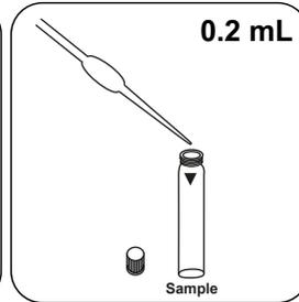
Adicionar **0.2 mL de amostra** à célula de amostra.
