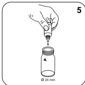
Adicionar 5 gotas Free Chlorine Reagent Solution à célula Cloro.
