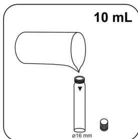
Encher uma **segunda célula** com **10 mL de amostra**.
