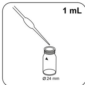
Adicionar **1 mL (25 drops) Polyacrylate Buffer A1 de solução** à célula de amostra.
