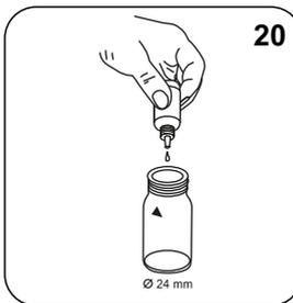
Adicionar **20 gotas KS251 (Chloride Reagenz A)**.
