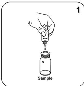
Adicionar **1 gota Ca Mg Hardness SOL 4 (frasco branco)** à célula de amostra.
