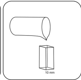
Encher a **célula de 10, 20 ou 50 mm** com amostra.
