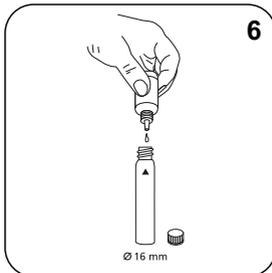
Adicionar **6 gotas H<sub>2</sub>O<sub>2</sub>-Reagent Solution**.
