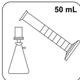
Filtrar cerca de 50 mL de amostra com um filtro pré-enxaguado (dimensão dos poros 0,45  $\mu\text{m}$ ).
