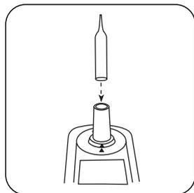
Colocar a ampola no compartimento de medição.
