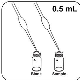
Introduzir em cada célula **0.5 mL VARIO Sulfide 1 de solução**.
