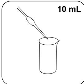
Encher um recipiente de amostra adequado com **10 mL de amostra**.
