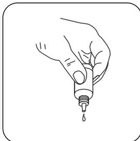
Mantiver os frascos conta gotas na vertical e pressionar lentamente para adicionar gotas de igual dimensão.
