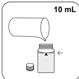
Encher a célula de 24 mm com **10 mL de amostra**.
