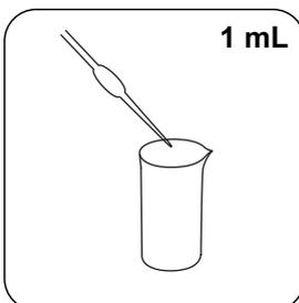
Adicionar **1 mL ácido sulfúrico concentrado** .
