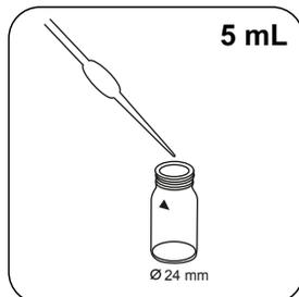
Adicionar **5 mL de amostra e 5 mL de água desmineralizada** à célula de amostra.
