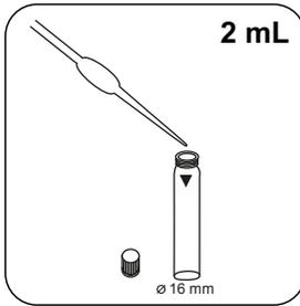
Adicionar **2 mL 1,54 N solução de hidróxido de sódio** da amostra digerida.
