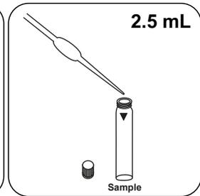
Adicionar **2.5 mL de amostra** à célula de amostra.
