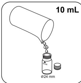
Encher a célula de 24 mm com **10 mL de amostra preparada**.
