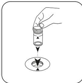
Colocar a **célula** Cloraminano compartimento de medição. Observar o posicionamento.
