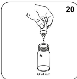
Adicionar **20 gotas KS253 (Chloride Reagenz B)**.
