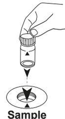
Colocar a **célula de amostra** no compartimento de medição. Observar o posicionamento.
