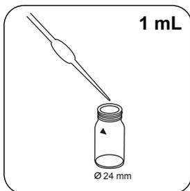
Adicionar **1 mL (25 drops) Polyacrylate Precipitant A2 de solução** à célula de amostra.
