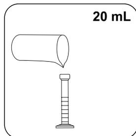
Introduzir **20 mL de amostra** num cilindro misturador de 25 mL.
