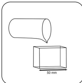
Encher a **célula de 50 mm** com a **amostra zero**.
