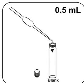
Adicionar **0.5 mL de água desmineralizada** à célula zero.
