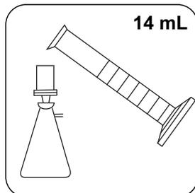
Filtrar cerca de 14 mL de amostra com um filtro pré-enxaguado (dimensão dos poros 0,45  $\mu\text{m}$ ).
