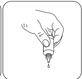
Manter os frascos conta gotas na vertical e pressionar lentamente para adicionar gotas de igual dimensão.
