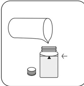
Encher a célula até à **marca de 10 mL** com **água desmineralizada**.
