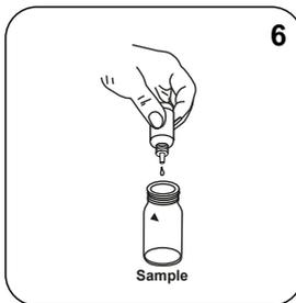
Adicionar **6 gotas PHENOL Red-Lösung** à célula de amostra.
