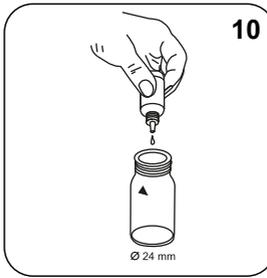
Adicionar **10 gotas** Hardness Total Buffer TH2.
