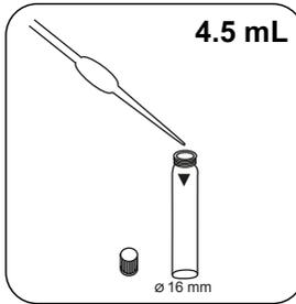
Adicionar **4.5 mL de água desmineralizada** à célula de digestão.
