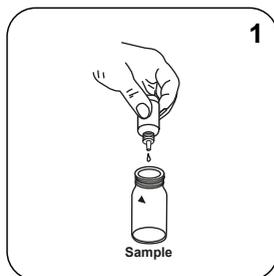
Adicionar **1 gota Ca Mg Hardness SOL 3 (frasco verde)** à célula de amostra.
