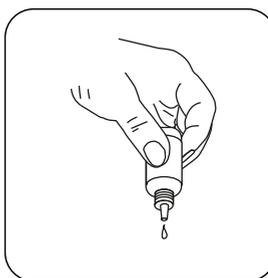
Manter os frascos conta gotas na vertical e pressionar lentamente para adicionar gotas de igual dimensão.
