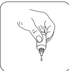
Adicionar **Hardness Calcium Buffer CH2** gota a gota da mesma amostra até aparecer uma coloração ligeiramente rosa a avermelhada. **(Atenção: assim que adicionar cada gota, agite a amostra!)**
