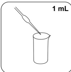
Adicionar **1 mL ácido sulfúrico concentrado** .
