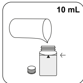
用 10 mL 样本填充 24 mm 密封比色杯。
