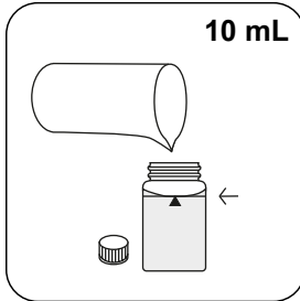
用 10 mL 去离子水填充 24 mm 比色杯。
