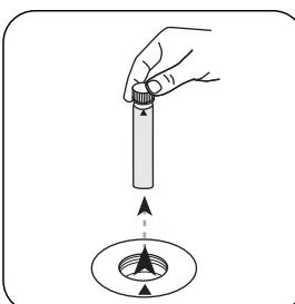
Prelevare la **cuvetta** dal vano di misurazione.
