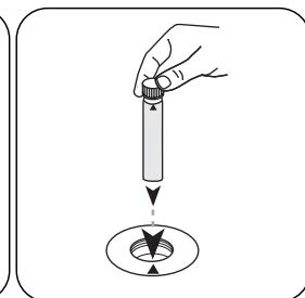
Die **Probenküvette** in den Messschacht stellen.
