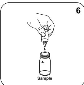
Ajoutez **6 gouttes de PHENOL Red-Lösung** dans la cuvette réservée à l'échantillon.
