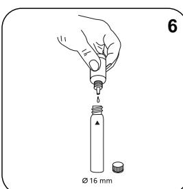
Adicionar **6 gotas H<sub>2</sub>O<sub>2</sub>-Reagent Solution**.
