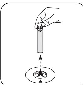
Prelevare la **cuvetta** dal vano di misurazione.
