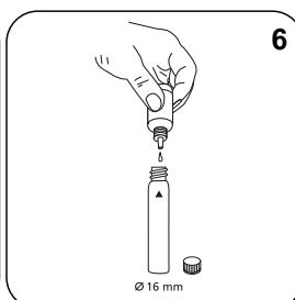
Adicionar **6 gotas H<sub>2</sub>O<sub>2</sub>-Reagent Solution**.
