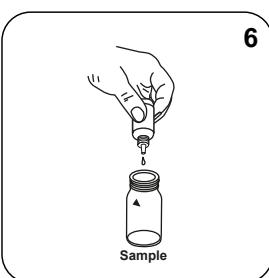
Adicionar **6 gotas PHENOL Red-Lösung** à célula de amostra.
