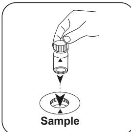
Die **Probenküvette** in den Messschacht stellen.
