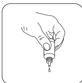
Mantar os frascos conta gotas na vertical e pressionar lentamente para adicionar gotas de igual dimensão.
