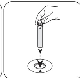
Die **Probenküvette** in den Messschacht stellen.
