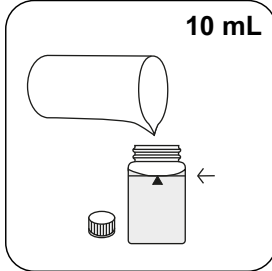
用 10 mL 去离子水填充 24 mm 比色杯。
