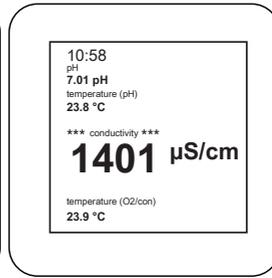
Der Messwert kann nun auf dem Display abgelesen werden. In der Parameterkonfiguration können Sie die Leitfähigkeit bei Bedarf auf TDS oder Salinität umstellen.
