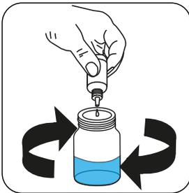
**Chlor (frei) LR Titrierlösung FCL2** oder **Chlor (frei) HR Titrierlösung FCL3** tropfenweise der Probe zugeben bis die Färbung von **farblos/lassgelb** bis **blau** umschlägt.
