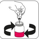
Añadir 6-8 gotas de Alkali- Añadir gota a gota Alka**linity Reagent ALK3** en la muestra hasta que adquiera una coloración de amarillo a rojo rosa.
