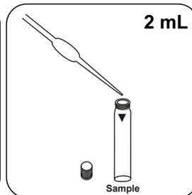
Versez **2 mL d'échantillon** dans la cuvette réservée à l'échantillon.
