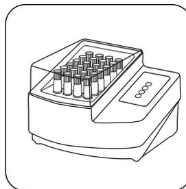
Fractionnez la(les) cuvette(s) dans un thermoréacteur préchauffé pendant **120 minutes à 150 °C**.
