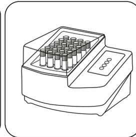
在预热的热反应器中，在 150°C 下密封比色杯 120 分钟。
