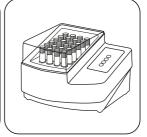
Disgregar la(s) cubeta(s) en el termoreactor precalentado durante 120 minutos a 150 °C .
