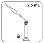
Versez 2.5 mL d'échantillon dans la cuvette réservée à l'échantillon.
