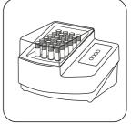
Fractionnez la(les) cuvette(s) dans un thermoréacteur préchauffé pendant 120 minutes à 150 °C.
