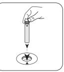
Placez la **cuvette du blanc** dans la chambre de mesure. Attention à la positionner correctement.
