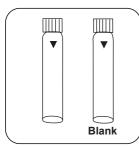
Préparez deux cuvettes de réactif. L'une des deux cuvettes sera la cuvette du blanc. Étiquetez-la.
