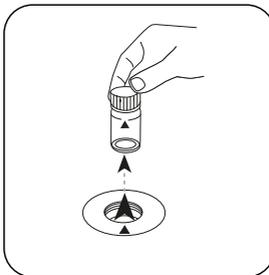
Prelevare la cuvetta dal vano di misurazione.
