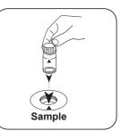
Colocar a **célula de amostra** no compartimento de medição. Observar o posicionamento.
