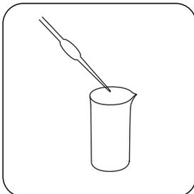
Añadir en el recipiente de muestra **2 mL de muestra y 8 mL de agua desionizada**.
