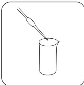
Immettere **2 mL di campione e 8 mL di acqua demineralizzata** nel recipiente del campione.
