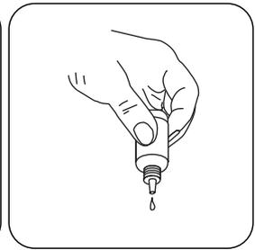
Tenere le boccette contagocce in posizione verticale e introdurre, premendo lentamente, gocce della stessa dimensione nella cuvetta.
