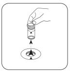
Küvette aus dem Messschacht nehmen.
