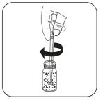
2 Minute(n) Reaktionszeit Gegebenenfalls Tablettenreste unter leichter Drehung zerdrücken.
