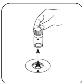
Prelevare la cuvetta dal vano di misurazione.
