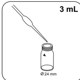
**3 mL Probe** in die Probenküvette geben.
