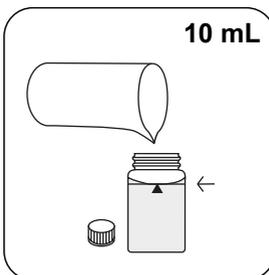
MD50: Remplissez une cuvette de 24 mm de **10 mL d'échantillon**.
