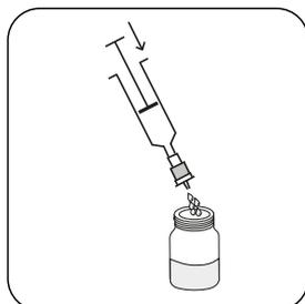
Filtrez d'échantillon avec un filtre (taille des pores  $0,45 \mu\text{m}$ ).
