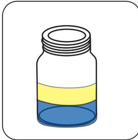
Laisser les phases se séparer. Une couleur bleue doit apparaître dans la couche inférieure si du produit est présent.
