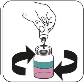
Ajoutez au goutte à goutte **Polyacrylate HR Titrant A5** ou **Polyacrylate HR Titrant A6** au échantillon jusqu'à obtention d'une coloration **bleu à gris/ rose**, dans la couche inférieure .
