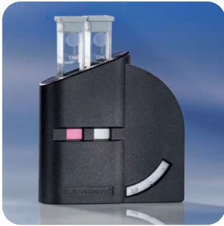
Frontansicht des CHECKIT® Comparators mit Küvetten
