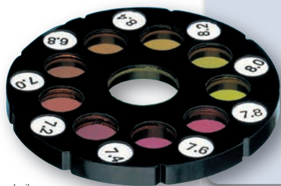
Farbscheibe mit farbbeständigen Glasstandards
