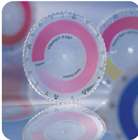
CHECKIT® Discs mit kalibrierten Skalen
